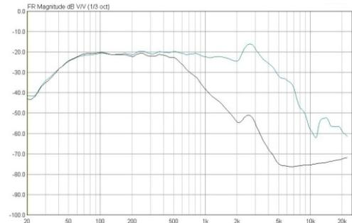
АЧХ головки B2502.4 при измерении по акустической оси головки с фильтром и фазоинвертором АС и стандартным фазоинвертором.
