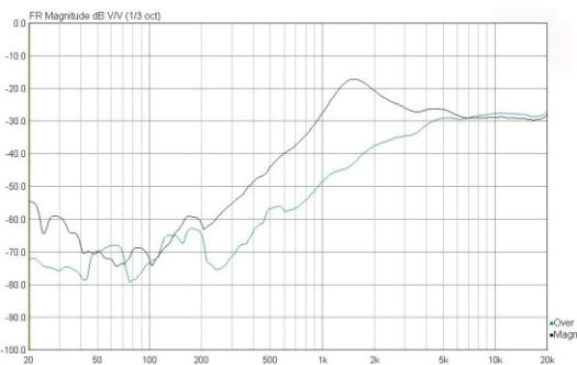
АЧХ головок MB1602.8 и T251.8 по оси головки ВЧ с фильтрами.
